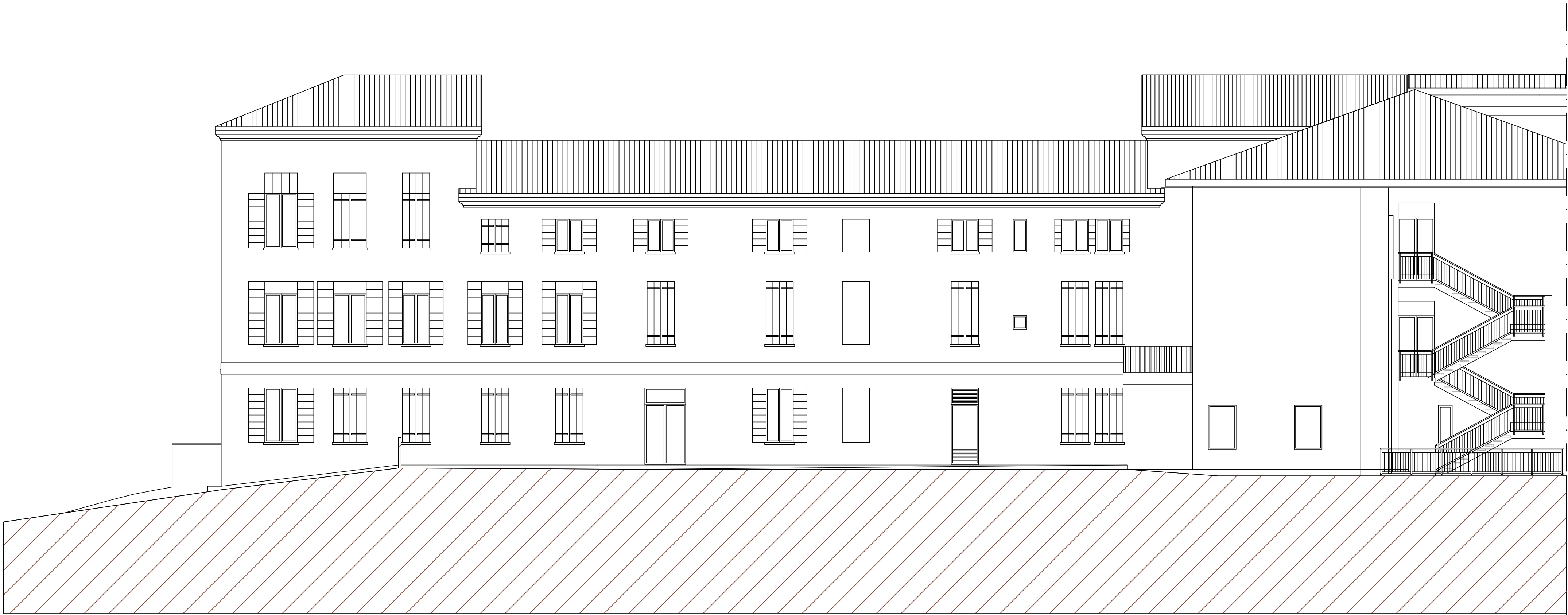
PROSPETTO NORD SCALA 1:100 VENGONO SOSTITUITI GLI SCURI CON MEDESIMA FORMA E TIPOLOGIA
