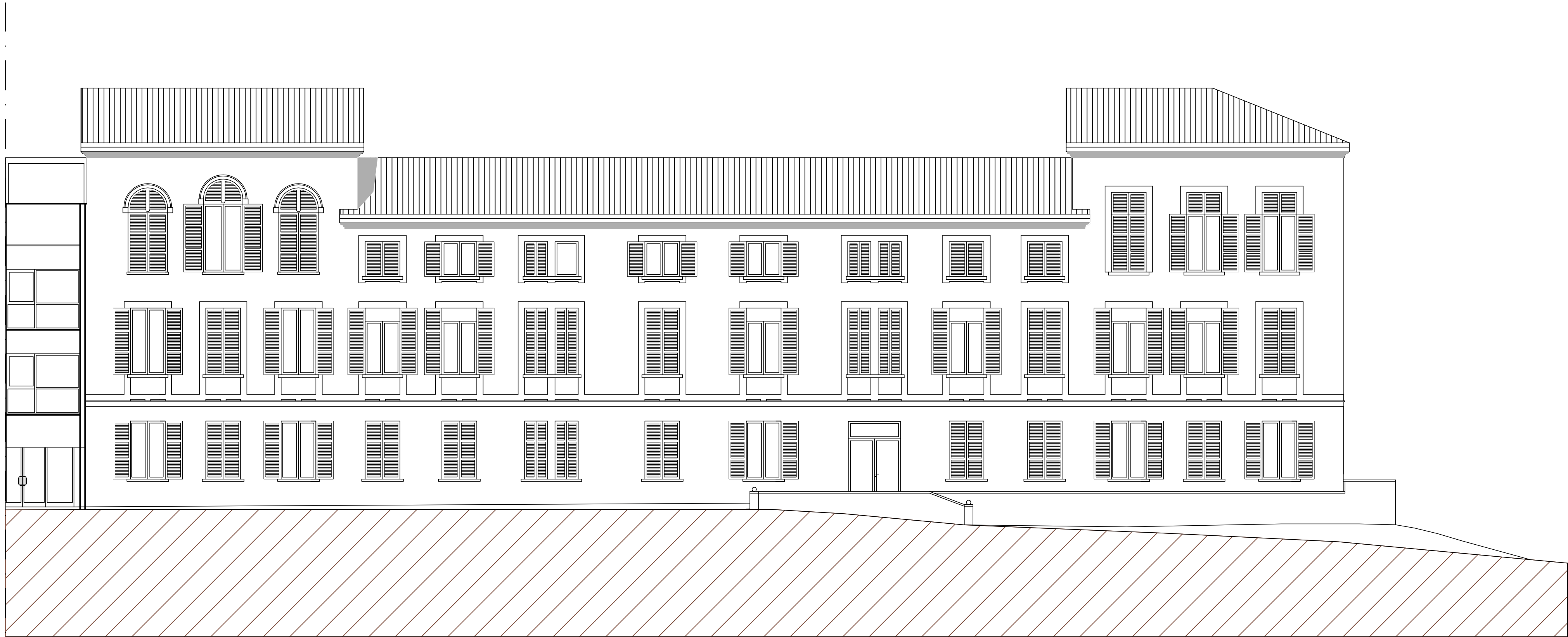
PROSPETTO SUD SCALA 1:100 VENGONO SOSTITUITI GLI SCURI CON MEDESIMA FORMA E TIPOLOGIA
